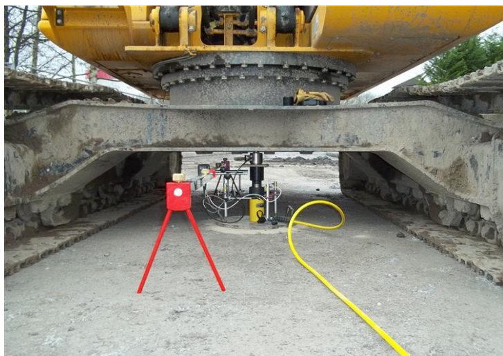
تامین عکس‌العمل به روش ثقلی با استفاده از وزن ماشین‌آلات
